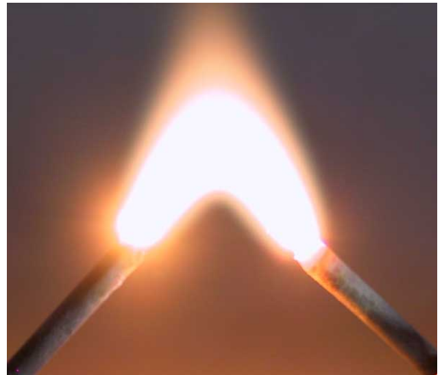
Arco eléctrico de 3000 voltios.
